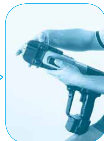
zaryglować zacisk poprzez zamknięcie bolca
