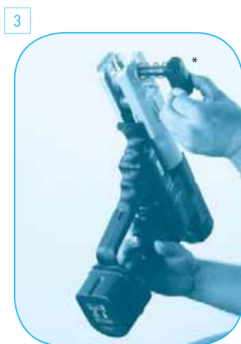
Odryglować bolec naciskając przycisk *
