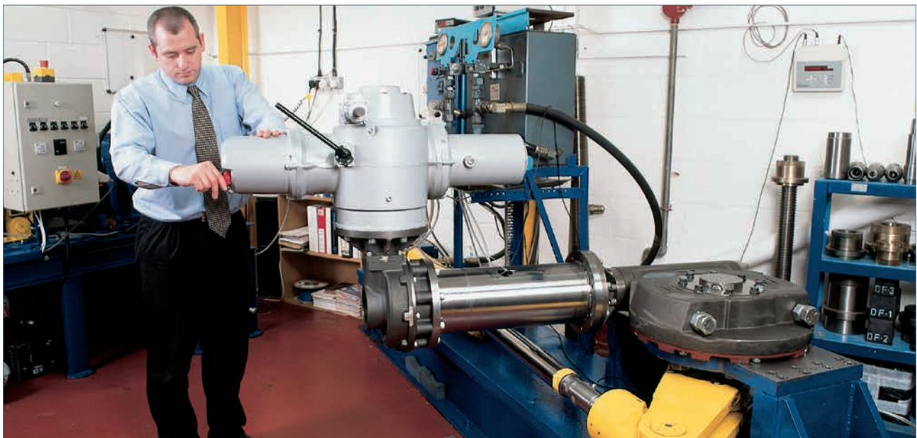
Testowanie trwałości prototypowej przekładni do zastosowań morskich/ głębinowych.
