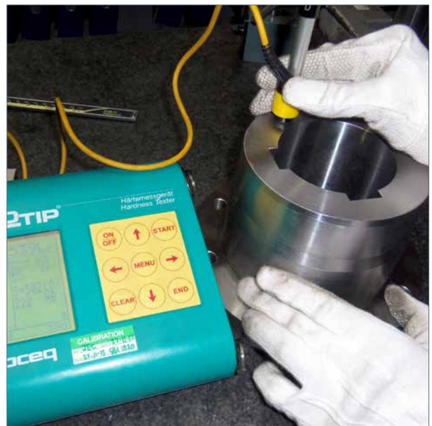
Sprawdzenie twardości tulei prowadzącej za pomocą testera Equotip.
