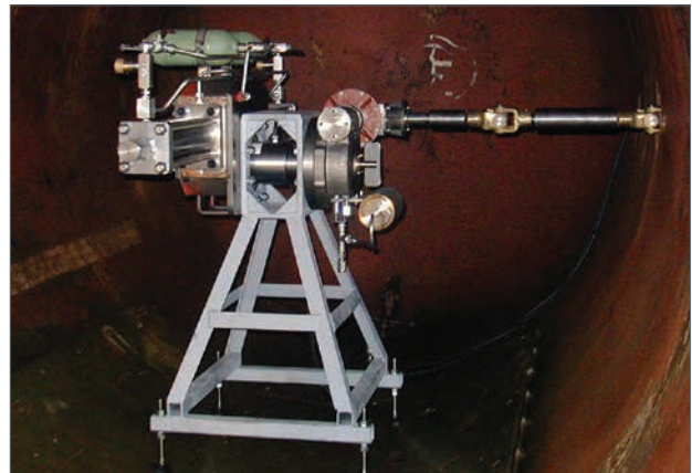
Hydrostatyczna kwalifikacja przekładni do zastosowań głębinowych.
