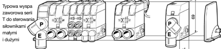
Typowa wyspa zaworowa serii T, złożona z zaworów o różnych natężeniach przepływu i realizujących różne funkcje.
